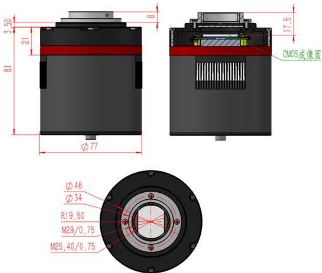
接有 C 转接环的 QHY174M/C 相机的尺寸图
