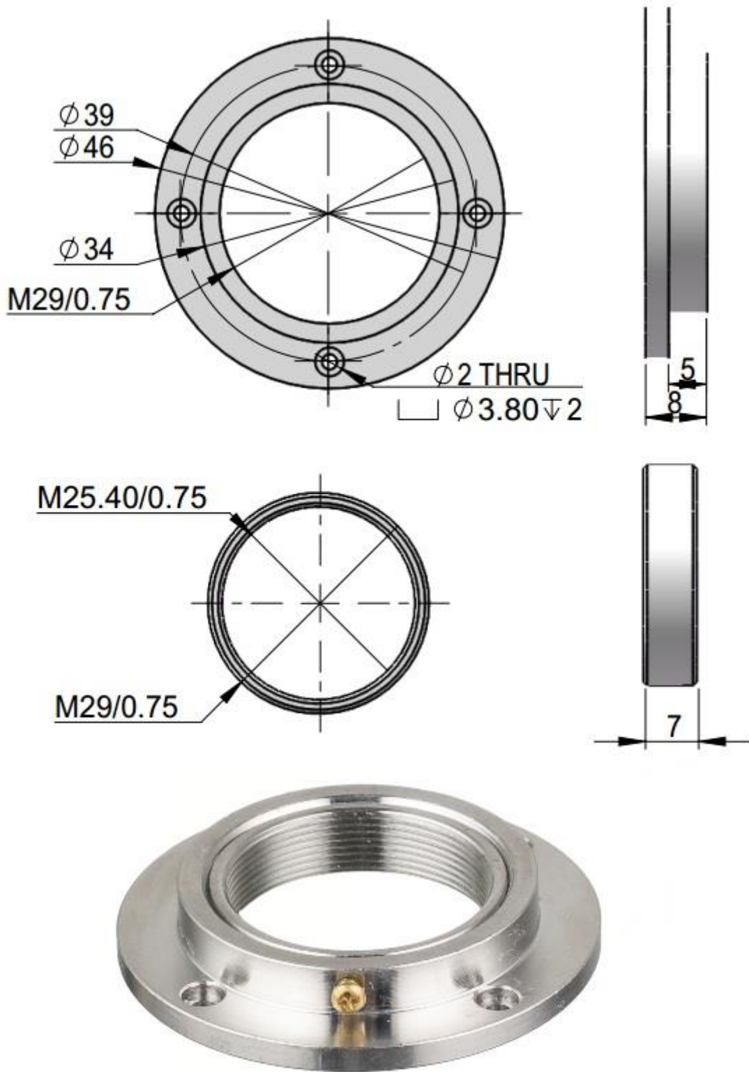
C口转接环尺寸图及实物图
