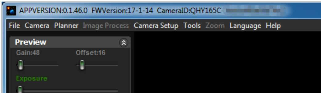
4. 在 Menu->Camera Setup 中点击 "Temp Control"，设置 CMOS 传感器的温度。您可以开启 "Auto Control" 和设定目标温度。比如，在此我们设置目标温度为-10C。CMOS 传感器的温度将会很快下降到此温度（大约需 2-3 分钟）。如果您想要关闭 TEC，您可以选择 "TEC OFF"。如果您只想设置 TEC power 而不设置温度，您可以选中 "Manual"，然后设置 TEC power 的百分值。
