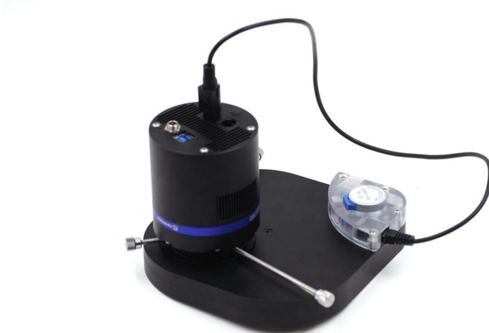
首先，您可以将 QHY163M 插入 QHYCFW2-M，然后按照上图拧入螺钉来固定。当您第一次拧螺钉时，您可能会觉得螺钉旋入有些困难，这时您要确保螺钉指向圆心并用一点力。当螺钉全部拧紧后，您就可以使用包装盒里的 DIN4/RJ11 线来连接滤镜轮至您的相机。
