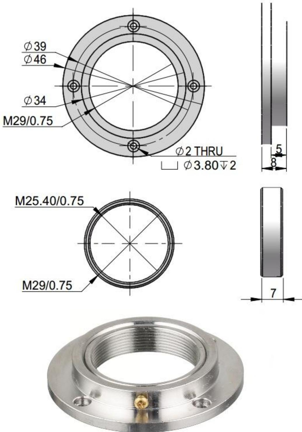
C口转接环尺寸图及实物图
